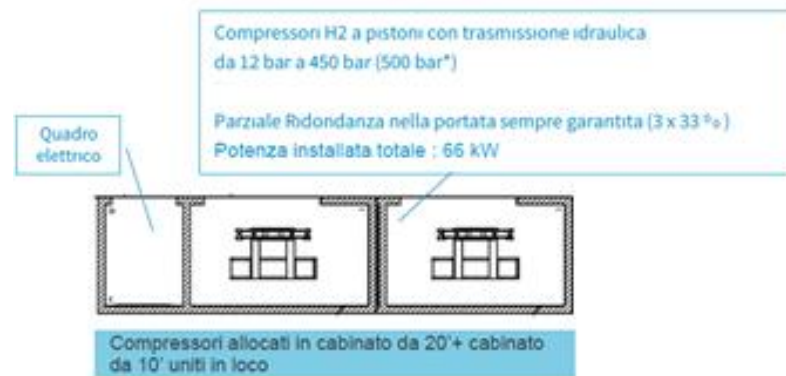
Figura 16. Configurazione tipica del container "compressione"(immagine esemplificativa)
